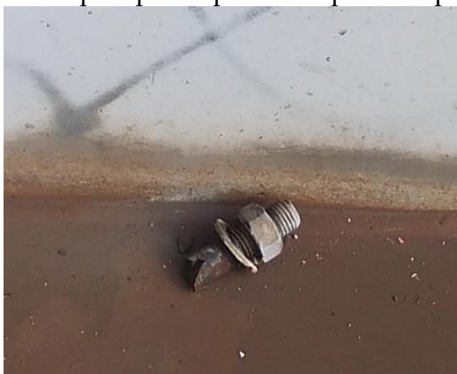
Obr. 207 Porušený šroub K02 – D9L
