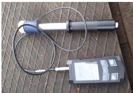
Obr. 185 Tvrdoměr typu KT-C se sondou typu G
