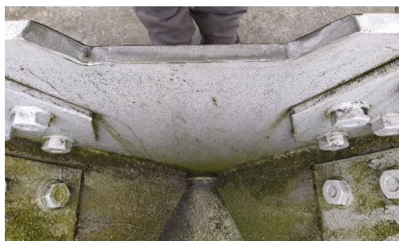
Obr. 190 Místo odběru vzorku po vybroušení a odmaštění
