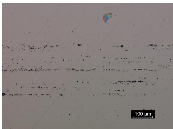
Obr. 5 Mikročistota vzorku D78P, zvětšení 100x
